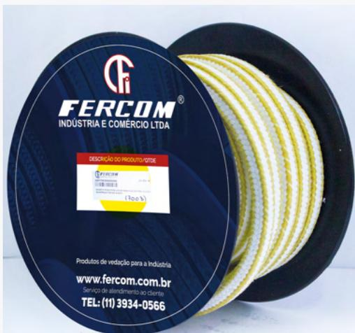
Gaxeta que combina PTFE e aramida, é dimensionalmente estável, possui excelente lubrificação e resistente mecanicamente. Pode trabalhar com ácidos, cáusticos e químicos em geral. Ideal para equipamentos rotativos, bombas, misturadores, agitadores e reatores, especialmente onde há sólido em suspensão.
