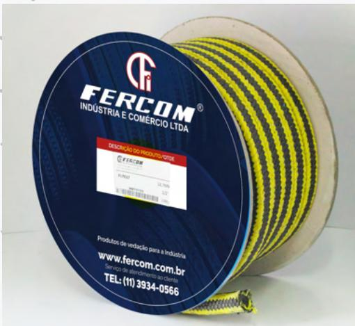
Gaxeta para serviço em quaisquer tipos de bombas, misturadores, reatores, haste de válvulas, em pressões elevadas, ideal para produtos abrasivos e fluidos com sólidos em suspensão. Combinação de resistência química do filamento em PTFE com grafite e a resistência mecânica do filamento em aramida que reforça os vértices.
