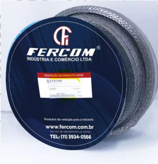
Gaxeta de alta performance e resistência mecânica dispensando o uso de anéis anti-extrusão. Possui em sua composição fios de grafite flexível para alta temperatura reforçados com malha de inconel, solução ideal para trabalhos severos em refinarias, petroquímicas, termoelétricas e outras situações nas quais existam altas temperatura e pressões no processo produtivo.
