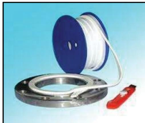
Produto elaborado a partir de 100% PTFE expandido, com estruturação de fibras uniformes e unidirecionadas. As fitas em PTFE expandido são excelentes para vedação de tanques, flanges frágeis (vidro, PRFV, Cerâmica, PVC, etc). Adere facilmente a qualquer tipo de união flangeada, mesmo com face de vedação irregulares, desgastadas, podendo ser aplicada nas mais severas condições de trabalho, como fluidos agressivos.
